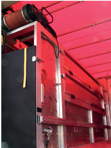
links: Blick in den Abrollbehälter »Wasserförderung«. In der Mitte sind die drei Rollcontainer gelagert. mitte: Blick auf das Schlauchfach mit den A-Druckschläuchen rechts: Im Abrollbehälter werden zwei Rollcontainer »Tragkraftspritze« mit PFPN 10-1 500 mitgeführt.
