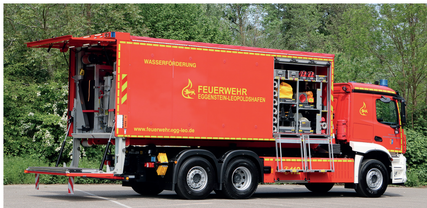
Der Abrollbehälter verfügt am Heck über eine teilbare Ladebordwand mit einer Tragfähigkeit von 1 500 kg. Die Geräteräume verfügen über ausziehbare Auftritte. Gut zu sehen ist die Umfeldbeleuchtung.
