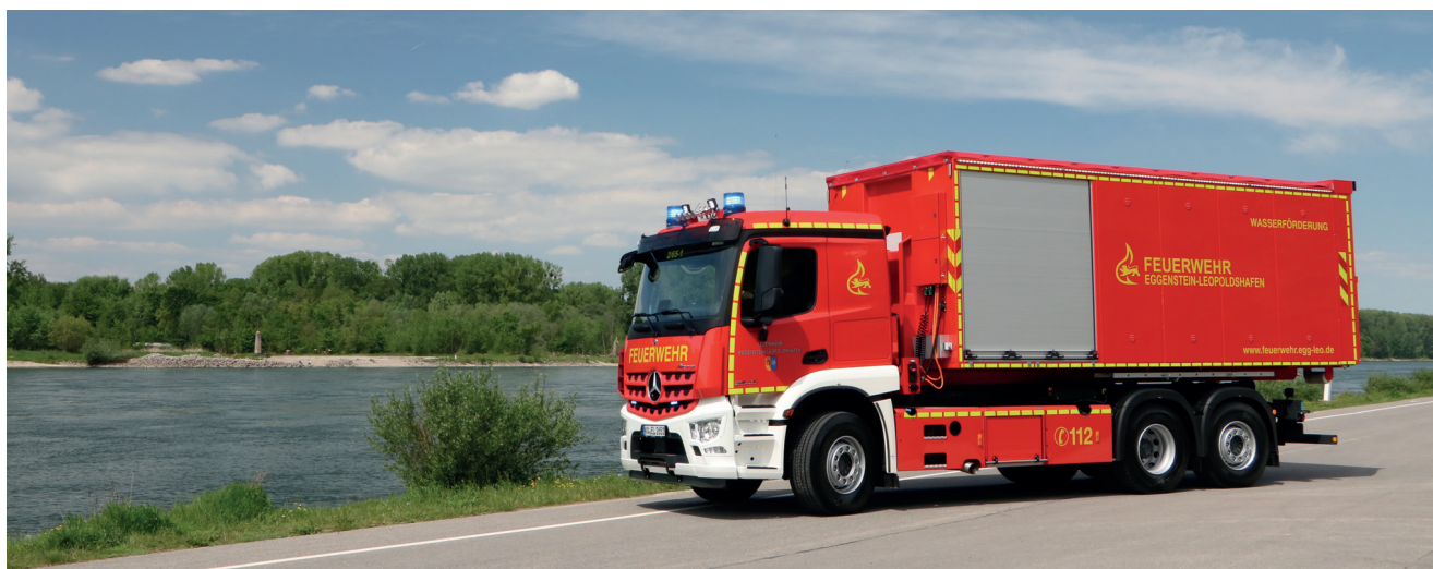
Einsatz für das WLF der FF Eggenstein-Leopoldshafen, Abteilung Leopoldshafen, mit dem AB-Wasserförderung am Rhein. Das Wechselladerfahrzeug ist ein MB Arocs 2543 L mit Aufbau von Meiller/F&B.
