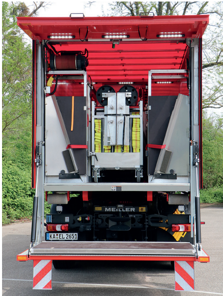
links: Blick in den Abrollbehälter »Wasserförderung«. In der Mitte sind die drei Rollcontainer gelagert. mitte: Blick auf das Schlauchfach mit den A-Druckschläuchen rechts: Im Abrollbehälter werden zwei Rollcontainer »Tragkraftspritze« mit PFPN 10-1 500 mitgeführt.
