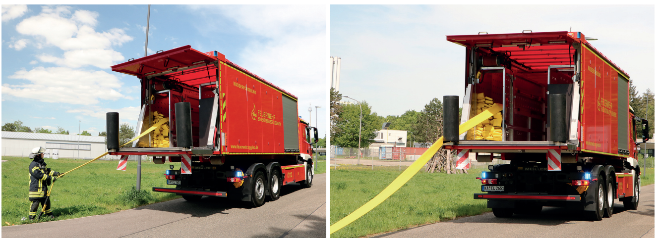
links: Der A-Druckschlauch wird an der Kunststoffrolle vorbei geführt. rechts: Die Schlauchverlegung kann mit hoher Geschwindigkeit erfolgen.
