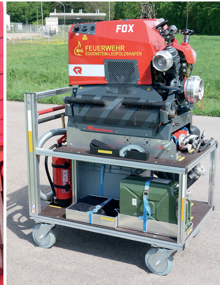
links: Blick in den Abrollbehälter »Wasserförderung«. In der Mitte sind die drei Rollcontainer gelagert. mitte: Blick auf das Schlauchfach mit den A-Druckschläuchen rechts: Im Abrollbehälter werden zwei Rollcontainer »Tragkraftspritze« mit PFPN 10-1 500 mitgeführt.
