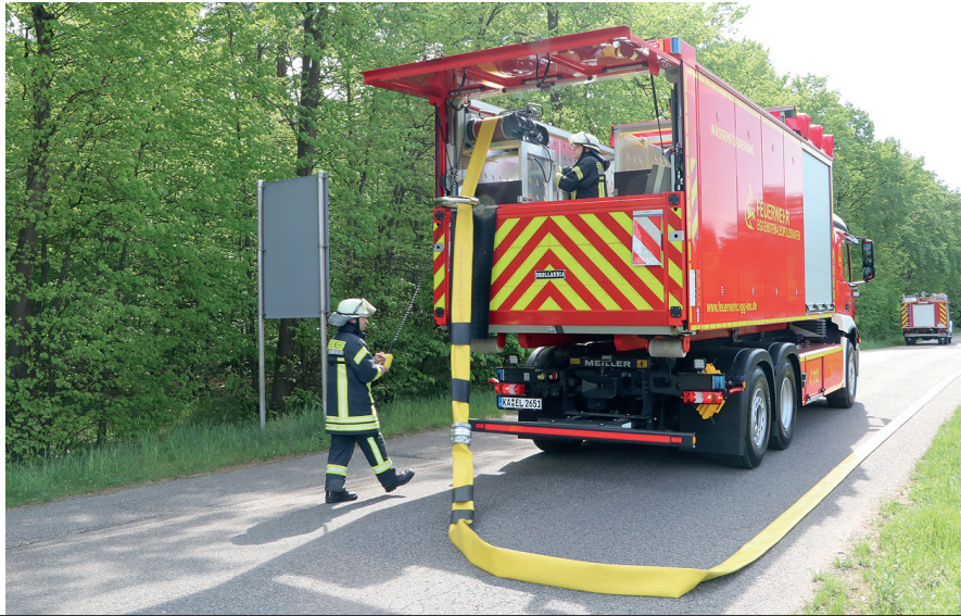
links: Zur Wiederaufnahme der ausgelegten Schläuche wird der Einholtrichter aus Edelstahl aufgesteckt. rechts: Danach kann die Aufnahme der nassen A-Druckschläuche erfolgen. Das Schlauchaufnahmeband wird vom Feuerwehrangehörigen außerhalb des Fahrzeuges bedient.
