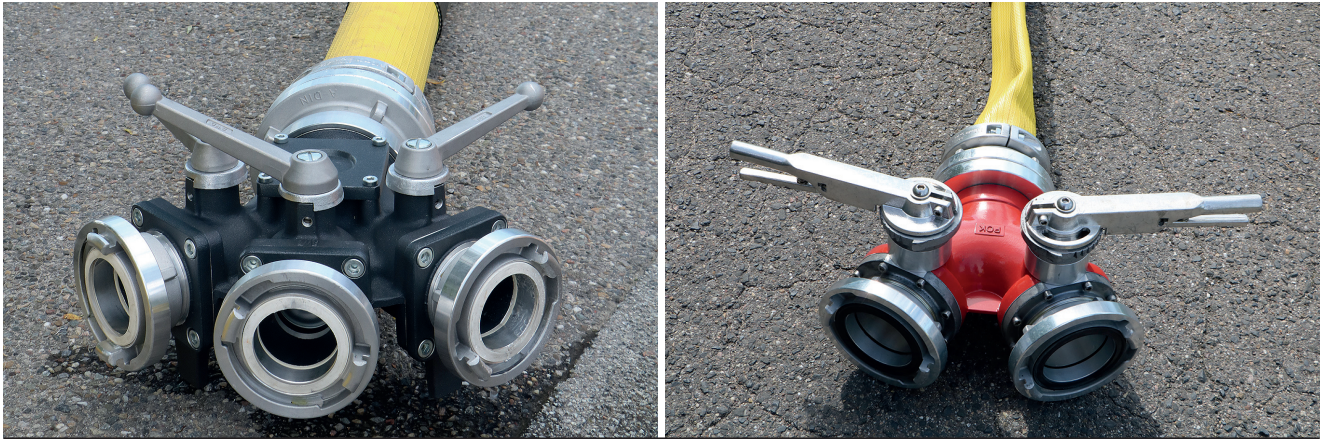
links: Zur Wasserabgabe stehen ein Verteiler A-3B ... rechts: ... und ein Verteiler A-2A zur Verfügung. Dieser dient vor allem zum Füllen der im Abrollbehälter mitgeführten Faltbehälter mit 5 000 Litern Inhalt.
