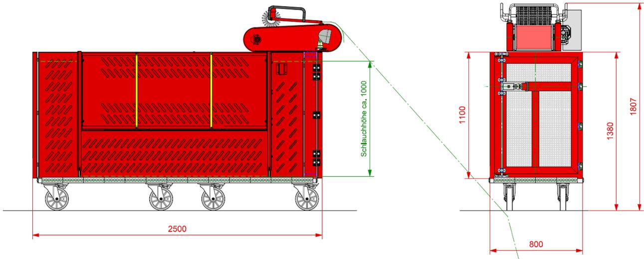
Schlauchkapazität ca. 900m B-Schlauch
