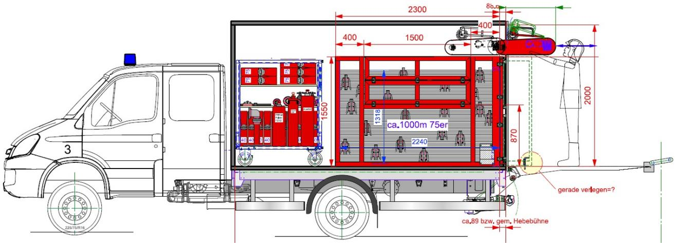
Schlauchkapazität ca. 1.000m B-Schlauch
