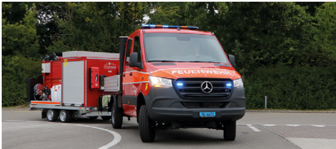
Einsatz des Schlauchverlegesystems der Feuerwehr Matzingen-Stettfurt auf einem 3,5-t-Brühlmann-Anhänger. Das Mehrzweckfahrzeug auf MB Sprinter 319 CDI 4 × 4 wurde ebenfalls von Brändle im Jahr 2020 geliefert. (Fotos: J. Thorns)
