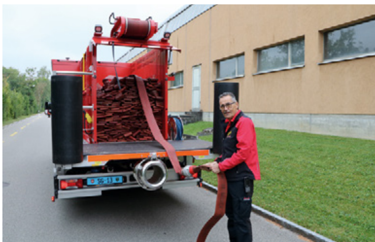
Brändle-Senior-Fachexperte »Technik« Fredy Röthenmund gilt als der Entwickler des Brändle-Schlauchverlegesystems. Gut zu sehen sind die Schlauchbox sowie am Heck der Einholtrichter aus Edelstahl.
