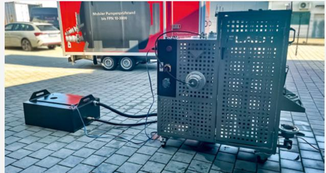
Wasserbehälter 125 Liter mit integrierter Pumpe als Ersatz für Netzwasseranschluß
